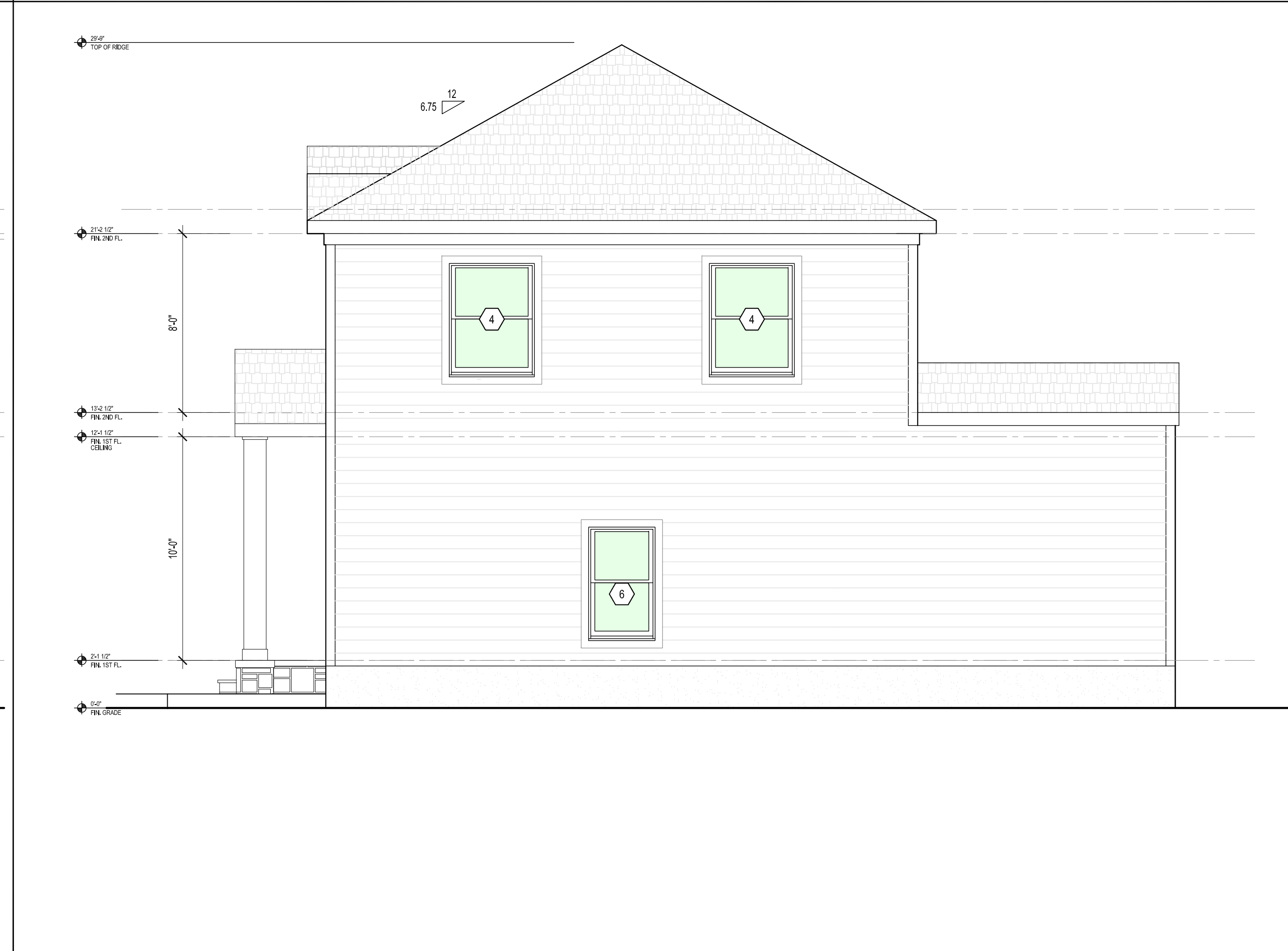
4 RIGHT ELEVATION SCALE: 1/4" = 1'-0"
